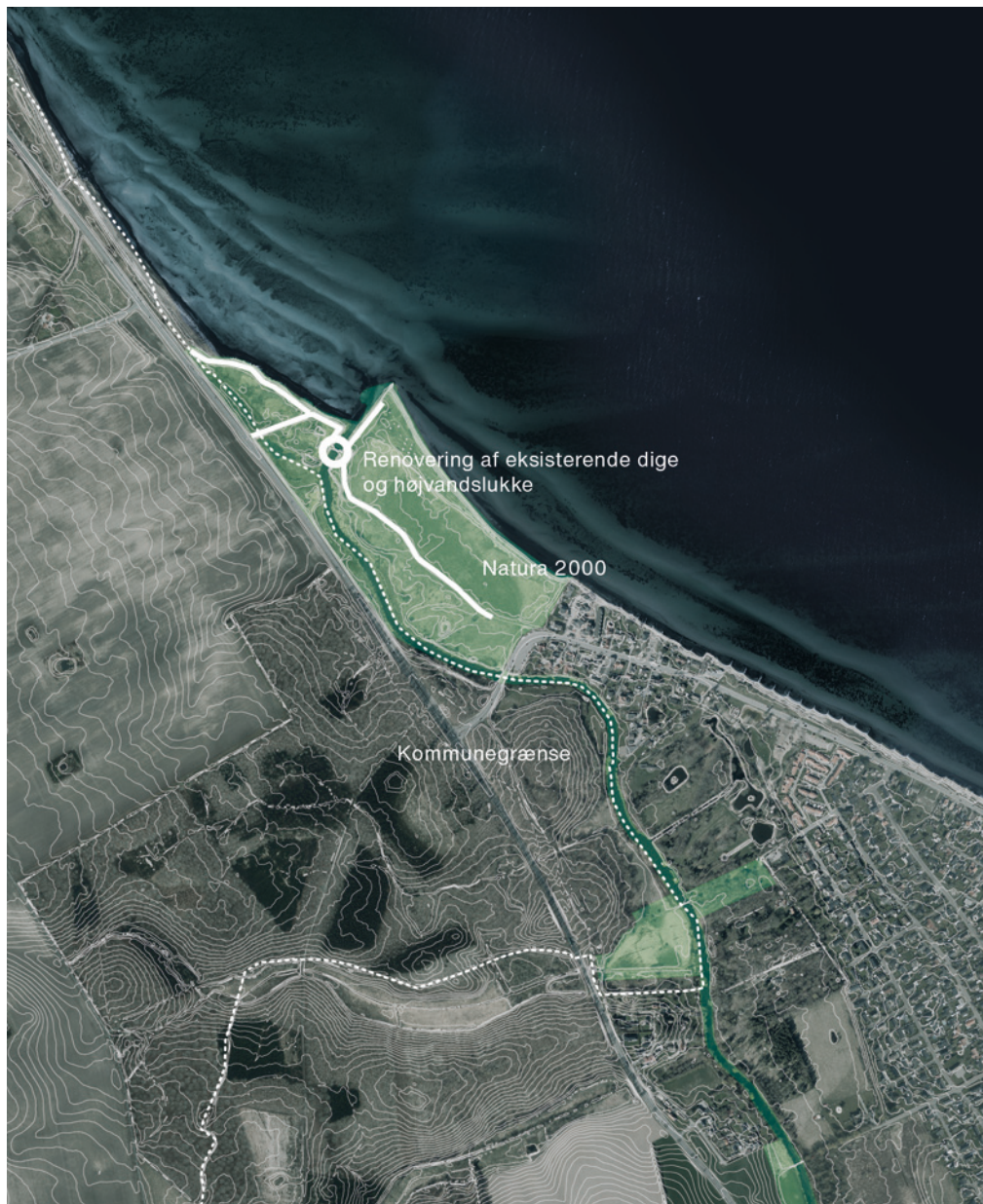
Kortet viser diger og højvandslukke på Odde som Stevns Kommune vedligeholder til kote 2,5 m DVR90
