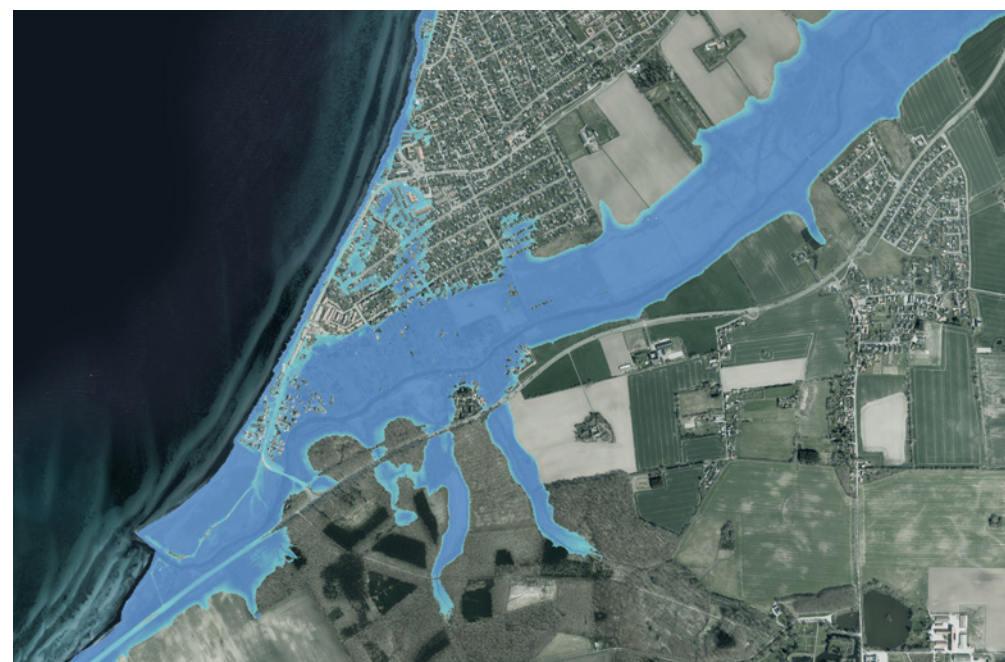
Odden og langs Tryggevælde Å, 1:30.000. Eksisterende forhold vist med vandstand i kote 2,8 m. Kilde: Scalgo
