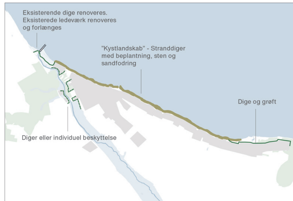
Fælles kystbeskyttelse med tekniske løsninger, der beskytter mod erosion og oversvømmelse
