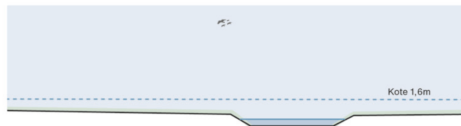
Principielt tværsnit A-A, 1:250 Løsning tæt på bebyggelse uden for åbeskyttelseslinje
