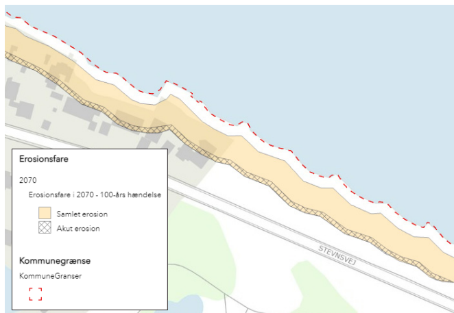
Jævnfør Kystplanlægger kan der i 2070 være forsvundet ca. 14 meter af kysten sammenlignet med i dag. Ved år 2120 kan op til 26 m af kysten være eroderet væk, herunder flere steder på Kystvejen og Stevnsvej. (Kilde: Kystplanlægger, erosionsfare 2070, 100 års hændelse).
